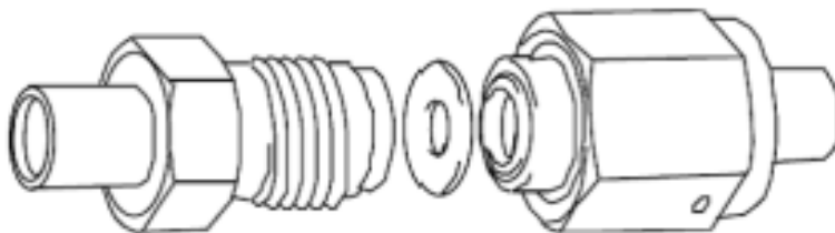
图四 VCR 接头的连接方法
